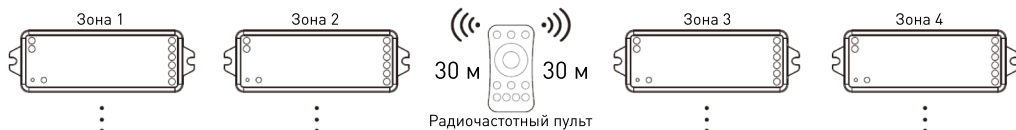
Рисунок 3. Расположение контроллеров в различных зонах
